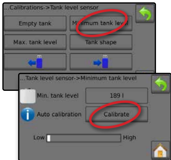
Figura 35: Sensor do nível do tanque – Nível mínimo do tanque
