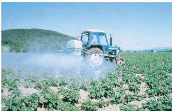
図1：これでは正しい農業散布とはいえません！ドリフトが大量発生しています。
