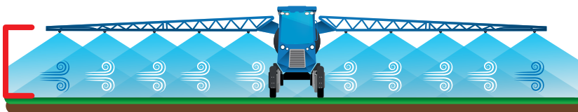
Altura de la barra de pulverización superior a la recomendada
