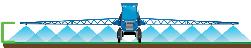
Altura de la barra de pulverización superior a la recomendada
